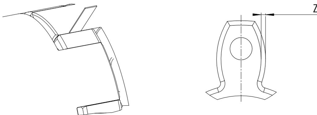
Qualora il valore misurato (quota **Z**) sia superiore a quanto riportato nella tabella QUOTA Z PER CONTROLLO USURA anello, si raccomanda di sostituire l'anello con uno corrispondente.
