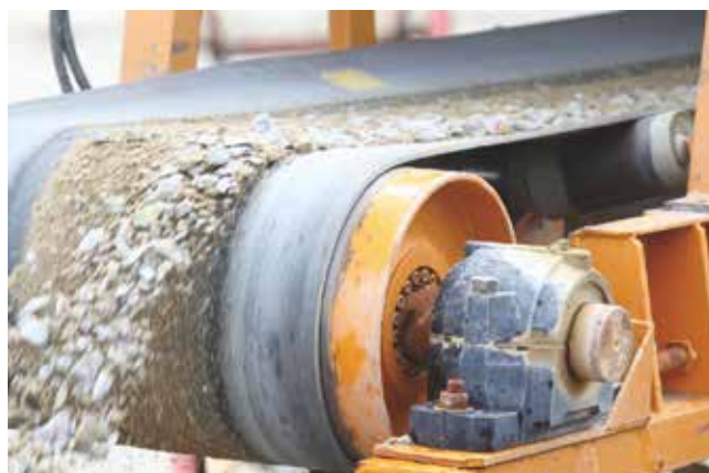
Applicazione di una puleggia di un trasportatore con SIT-LOCK® 1.
